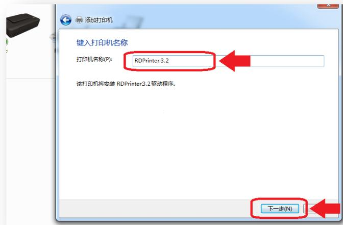
⚠️ 点击 [ 下一步 ( N ) ], 可能会显示与安装有关的 [ 警告 ] 文字。请忽略直接选择 [ 开始安装 ]。安装开始。
