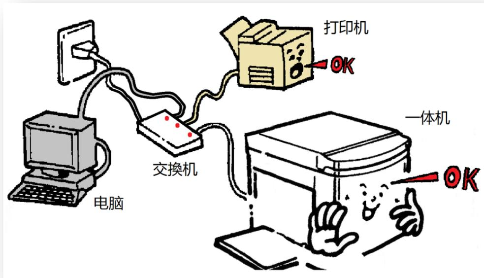
在已有网络覆盖的区域内，将一体机与网络相连接，这样网络区域内的所有人都能使用该一体机。但是使用网络打印功能前，各使用者都需在电脑上安装一体机驱动器。
