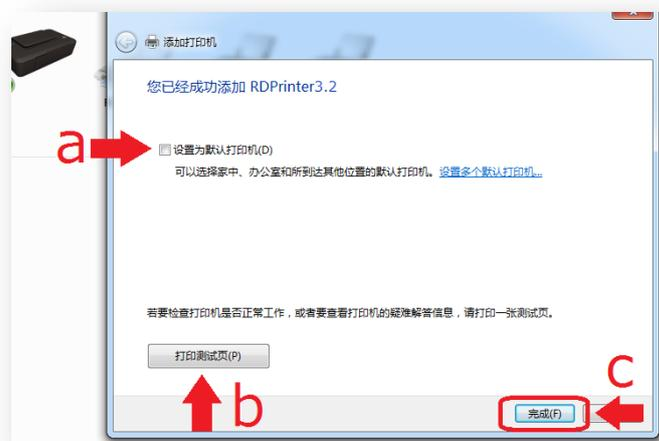
⚠️ 如果点击 b) [ 打印测试页 ( P ) ]、将使用网络打印功能输出测试印纸。
