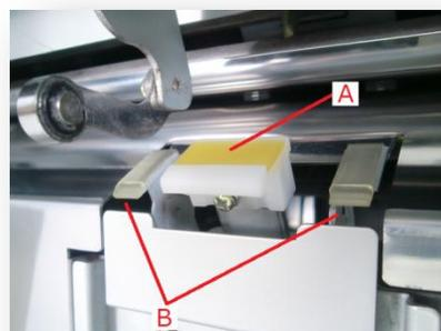
旋钮 ( A ) 调节分纸片 ( A ) 的强度，旋钮 ( B ) 调节进纸挡纸块 ( B ) 的高度。通常使用 ( A ) 旋钮调节分纸压力，旋钮 ( B ) 转至最左边。
