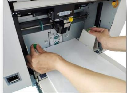
ii) 左右移动压纸条进行印刷用纸位置调节。
