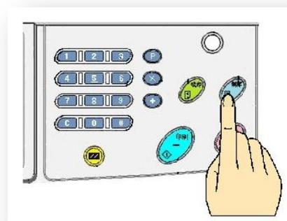
v) 显示信息发生变化时放入第二张原稿。机器将自动进行扫描、试印。
