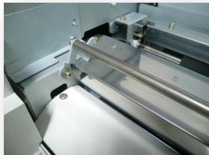
v) 取下蜡纸卷芯上的左右蜡纸筒支架，安装在新的蜡纸芯上。
